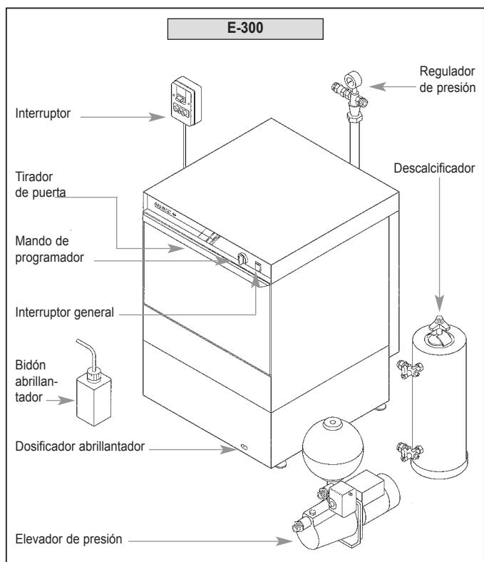
Conectar el elevador por un extremo a la llave de corte y por el otro a la manguera que se suministra con la máquina.
