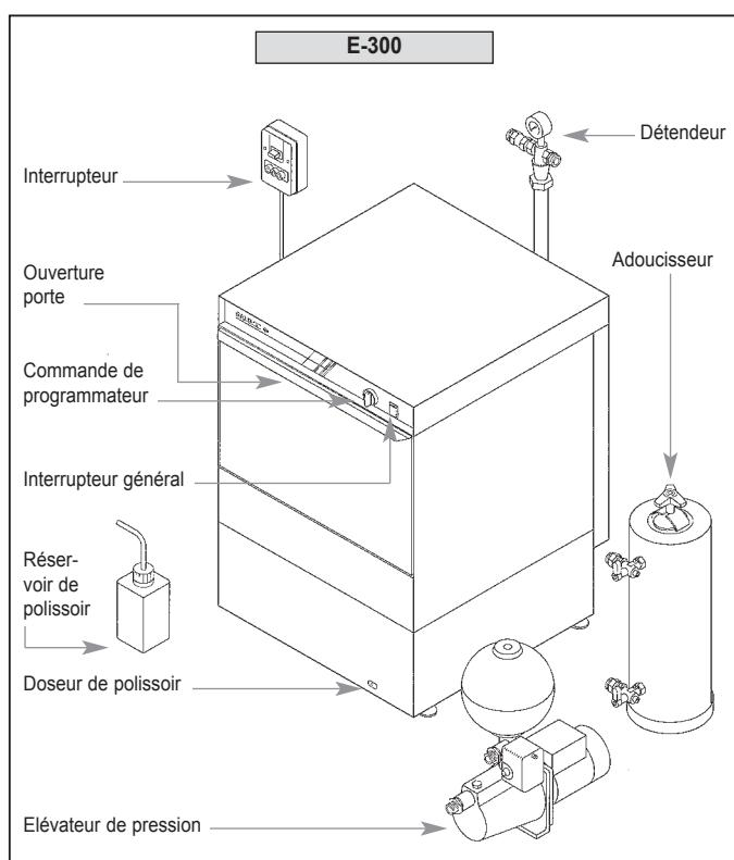
Connecter l'élévateur par une extrémité au robinet de fermeture et par l'autre, au moyen du tuyau, au raccord situé dans la machine.
