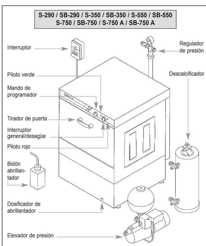
**Importante:** Comprobar que el depósito de abrillantador está lleno. Mediante giros del programador, 7 ó 8 impulsos, ver que el tubo de abrillantador se llena y entra en el calderín.
