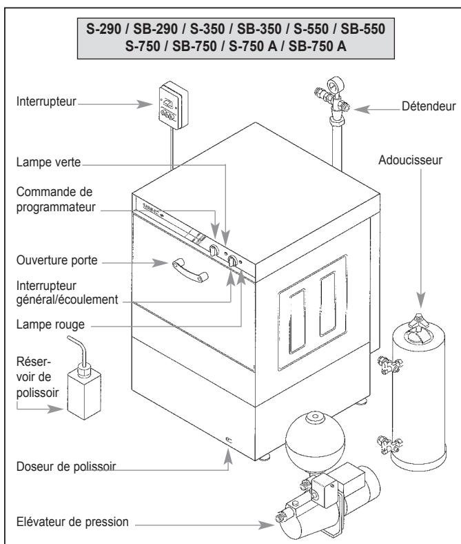
**Important:** Vérifier que le réservoir de polissoir est plein. En tournant le programmateur, 7 ou 8 élans, nous devons voir le remplissage du tuyau de polissoir et l'entrée dans la chaudière.
